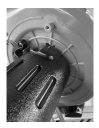
Inserire il sacchetto di raccolta del materiale triturato nel tubo ricurvo. Il lato del tubo ricurvo da inserire nel condotto di espulsione del soffiatore
