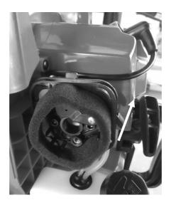
Rimuovere il filtro dell'aria e lavarlo con acqua e sapone oppure con aria compressa. Successivamente riporre il filtro asciutto nel vano e richiuderlo accuratamente.
